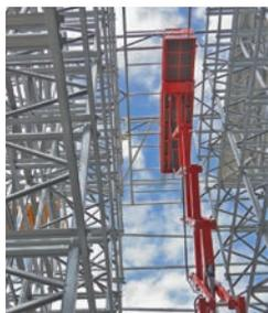
Die GS 225-12 WI verfügt über ein Gesamtgewicht von 9.750 kg und bleibt damit unter der 10-Tonnen-Grenze. Dies macht sich insbesondere bei den Transportkosten positiv bemerkbar.
