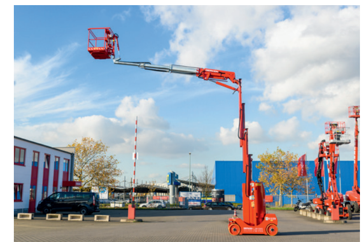
► Gerätebestand ausgebaut: Die GTM 150-12 W erreicht 8,01 Meter Reichweite und 14,97 Meter Arbeitshöhe bei gerade einmal 1,20 Meter Breite.
