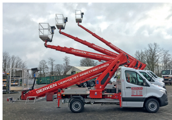
▼ GL 30 M und GL 30 M: sind seit Februar 2020 exklusiv im Gerken Mietpark. 30 Meter Arbeitshöhe auf 3,5-t-Fahrgestell fahrbar mit Führerscheinklasse B und mit bis zu 300 kg Korblast.
