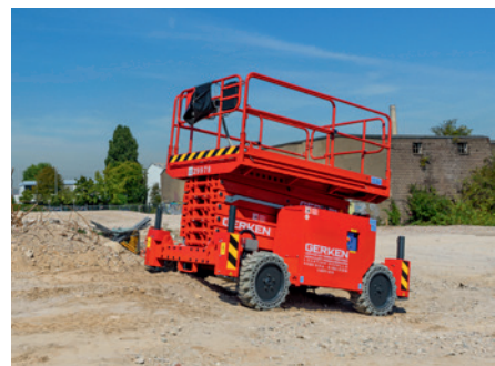
▲ Mit ihrem elektrischen Allradantrieb kann die GS 148-18 WASPH z. B. in geschlossenen Hallen eingesetzt werden, die noch nicht über einen festen Boden verfügen.
