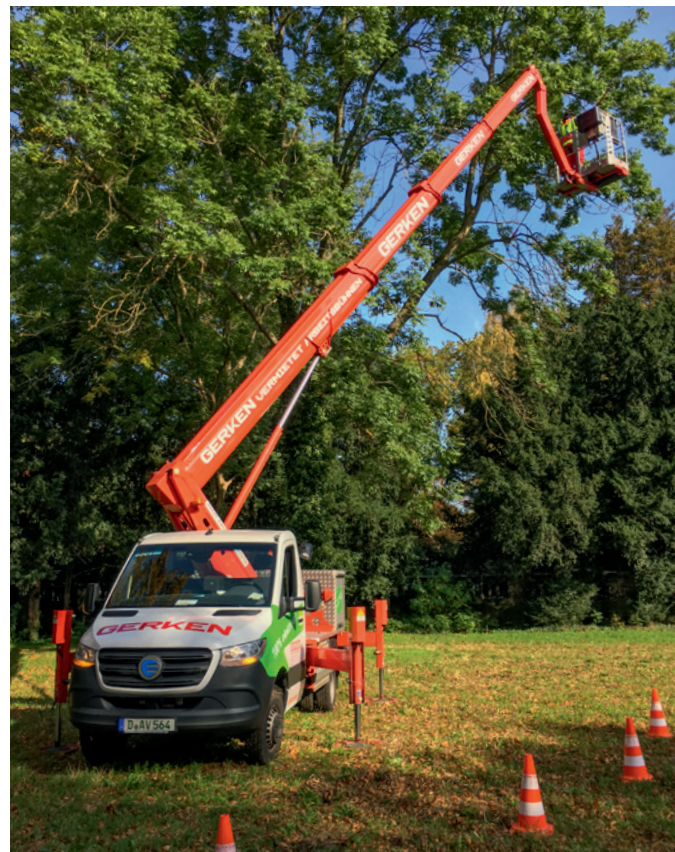
▲ Die vollelektrische LKW-Arbeitsbühne GL 25 N Elektro erfreut sich bei den Baumpfleger*innen allergrößter Beliebtheit. Himmlische Stille bei der Bedienung der Maschine, keine Abgase für Passanten und die Kommunikation mit den Kollegen am Boden geht fortan ohne Funkgerät.
