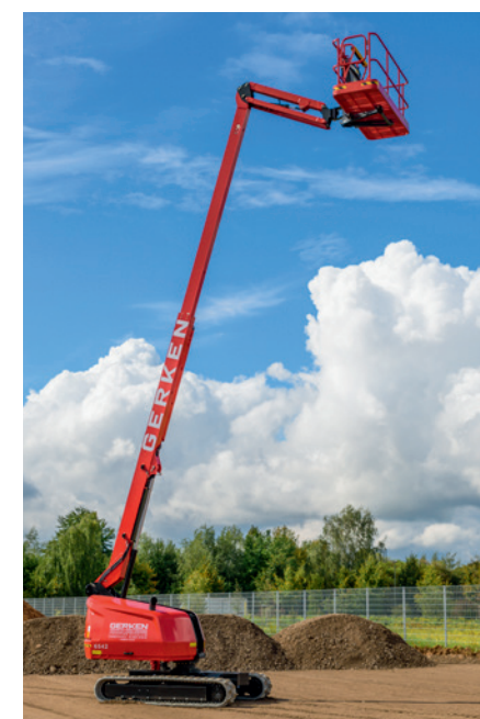
► Gerätebestand ausgebaut: Die GTM 150-12 W erreicht 8,01 Meter Reichweite und 14,97 Meter Arbeitshöhe bei gerade einmal 1,20 Meter Breite.
